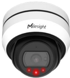
Integrierte IR-Beleuchtung zur Nachtsicht
