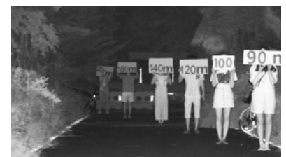
Mehrzonen IR-Beleuchtung mit hoher Reichweite ohne Überblendungen
